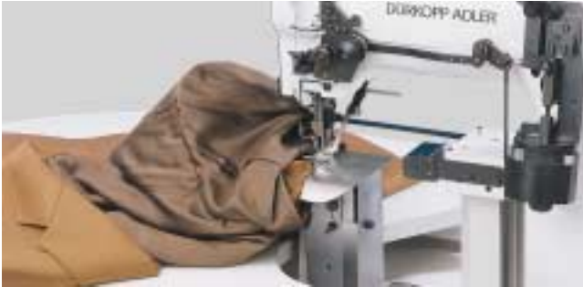
Arbeitsgänge der 697-15155: Wattelinestreifen knapp neben der Armlernaht einnähen, Armelfutter in Armlöcher nähen
