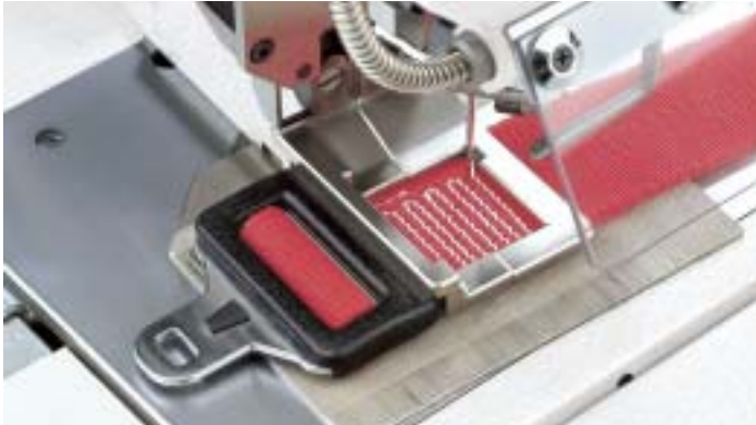
Riegel an Sicherheitsgurten mit Nahtbild F 116-15 (116 Stiche); Nähzyklus: ca. 10 Sek. Backstitches in a safety belt with seam pattern F 116-15 (116 stitches); sewing cycle: approx. 10 sec.
