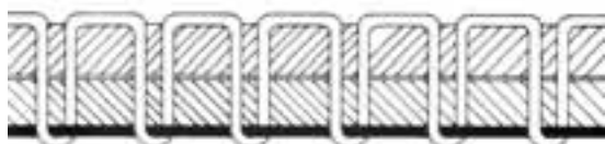
Fig. B: Tensão da linha da agulha muito fraca ou tensão da linha da lançadeira muito forte
