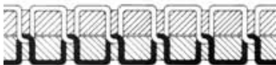
Fig. A: Entrelaçamento correcto da linha no centro do material
